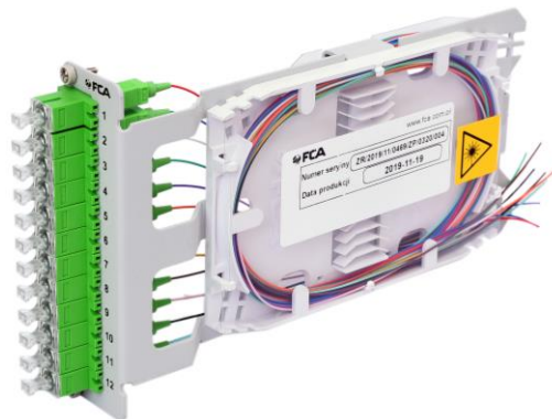
Wyposażony moduł kasetowy KMK-E-12 w kasetę z pokrywką, pigtaile i adaptory (zamawiane oddzielnie)
