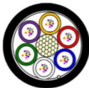
Mikrokabel światłowodowy o konstrukcji 6-tubowej
