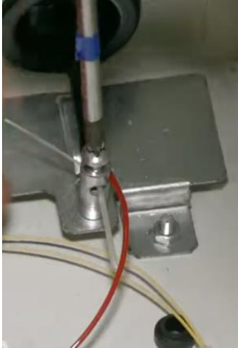
Fot.3 Mocowanie uchwyty wytrzymałościowego
