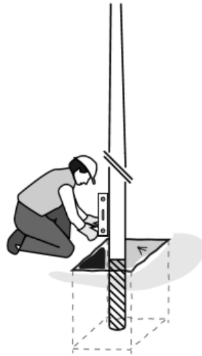
Rys.5. Pionowanie słupa przed zasypaniem wykopu/otworu montażowego
