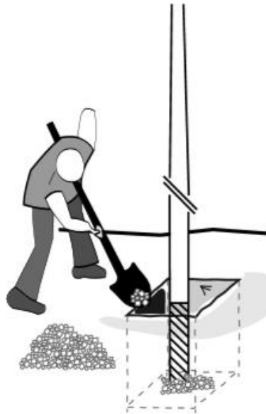
Rys.6. Zasypanie wykopu/otworu montażowego.
