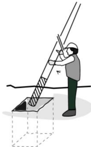
Rys.4. Usadowanie słupa w przygotowanym wcześniej wykopie/odwiercie.
