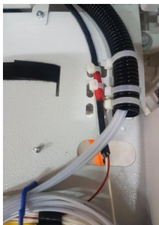
Fot.11a - Mocowanie w insercie kabla liniowego i peszla
