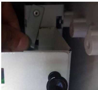
Fot.7 - Uchylanie modułu podnosząc blokadę
